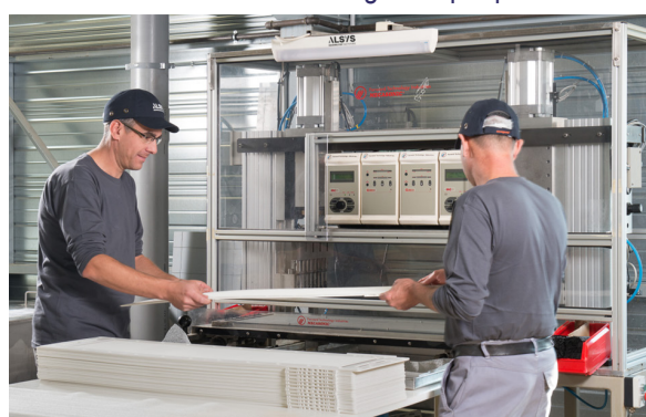
Machine d'assemblage des plaques
