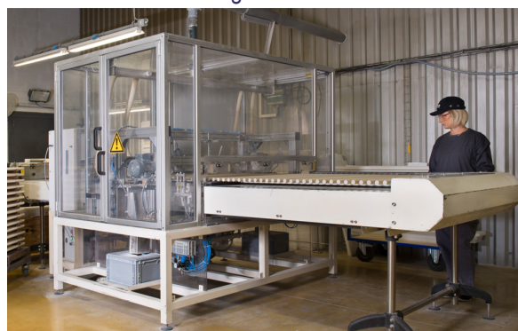
Machine de découpe des membranes et de gravure laser
