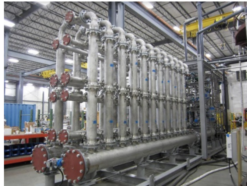
CeraMem®过滤设备系统。 流速: 600gpm (135m 3 /小时)
